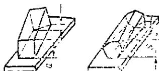
Суммарное скручивание прутка не должно превышать произведения величины допускаемого скручивания 1 м на длину прутка в метрах.
